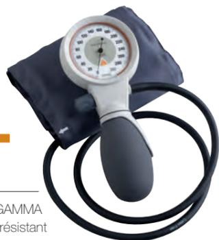
Mêmes caractéristiques que GAMMA G7, sauf : boîtier en plastique résistant avec un revêtement antidérapant absorbant les chocs. Cuillère réglable pour utilisation de la main droite ou de la main gauche.
